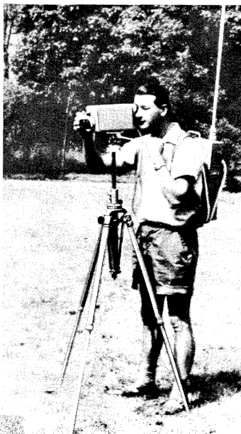
Bild 2. Mit dieser Anlage ist der Fernsehreporter unabhängig von der Kabelverbindung zum Übertragungswagen
